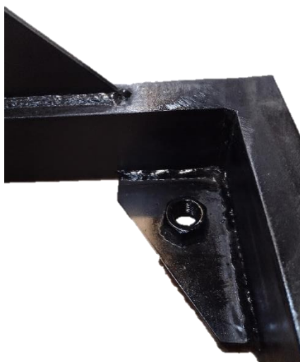
Figura 4 - Detalhe da porca para parafuso de nivelamento
