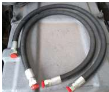
Foto da mangueira para o fluido GLP, com terminais prensados
