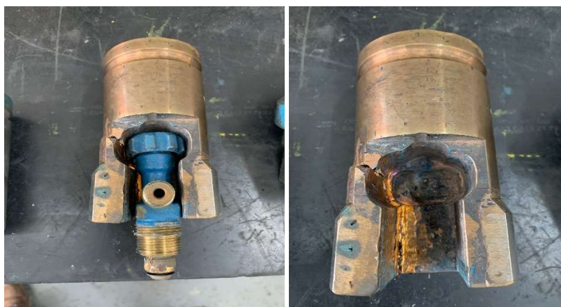
Soquete antifaísca trincado com extração de poucas válvulas.
