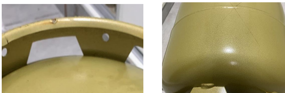
Figura 5 – Salt Spray 45 horas (Isento de oxidação, Aprovado).
