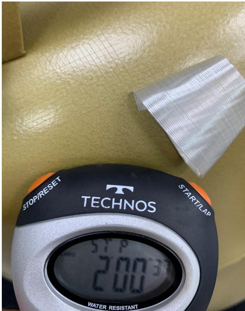
Figura 7 – Aderência no raio do meio corpo inferior (GR0, Aprovado).
