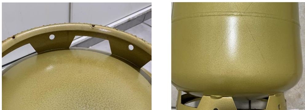
Figura 4 – Salt Spray 30 horas (Isento de oxidação, Aprovado).
