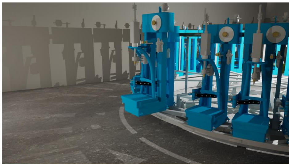
Figura 16 - Processo de Montagem da Balança no Carrossel
