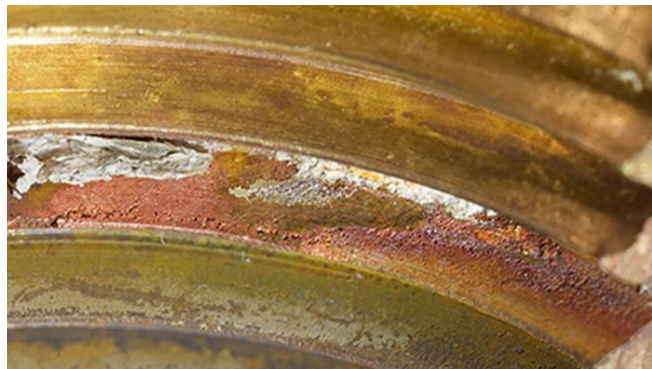
Figura 12 - Corrosão por rompimento seletivo
