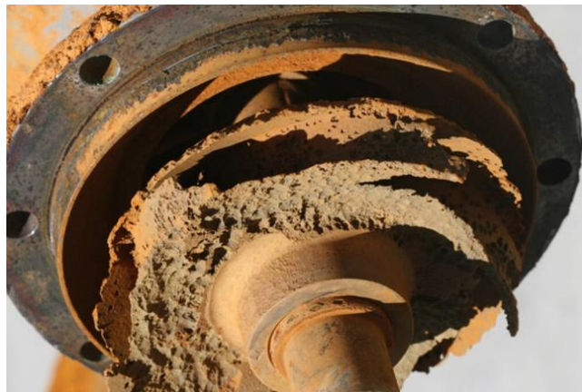
Figura 13 - Corrosão por erosão
