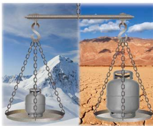
Figura 1 – Ilustração da variação do volume com a temperatura, embora a massa contida permaneça a mesma, sem alterar a balança. Fonte: [1]
