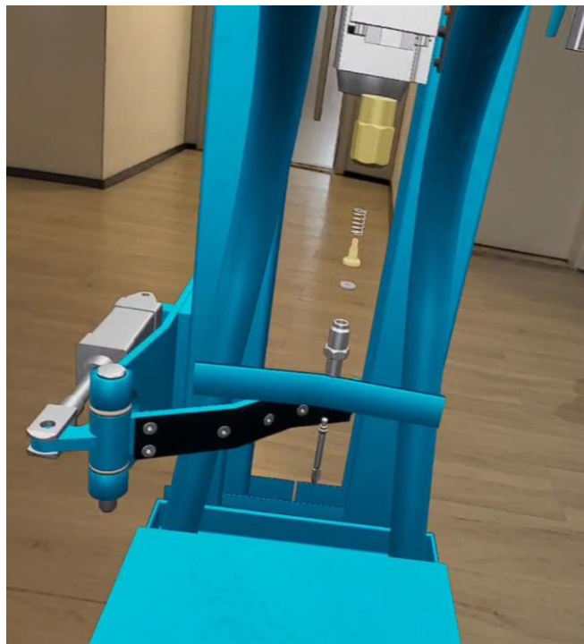
Figura 8 - Análise da montagem do bico de injeção de uma balança de enchimento de gás
