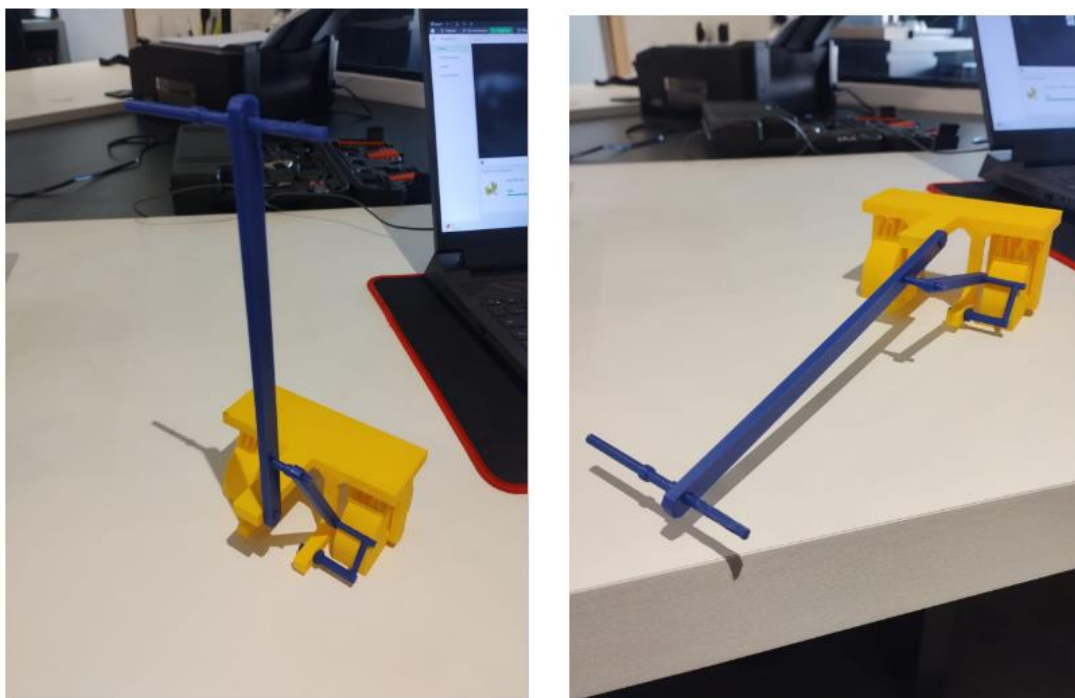
Figura 12 - Análise do mecanismo de quatro barras para freio de plataforma móvel
