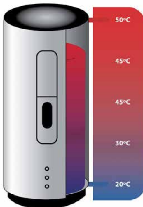
FIGURA 9 – ESTRATIFICAÇÃO DE ÁGUA DE ACORDO COM A TEMPERATURA EM UM RESERVATÓRIO DE ÁGUA QUENTE.
