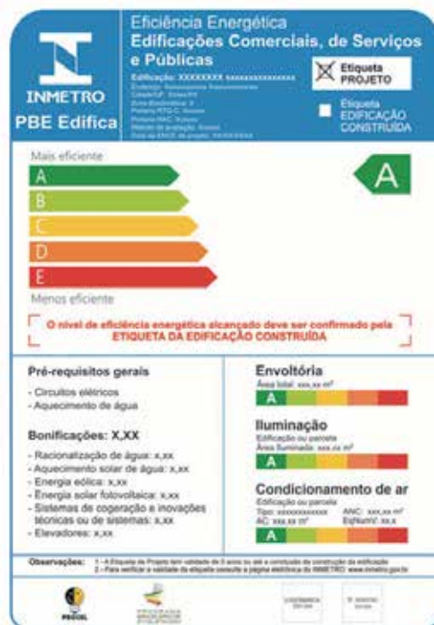
FIGURA 6 – ENCE COMPLETA PARA EDIFICAÇÕES COMERCIAIS.
