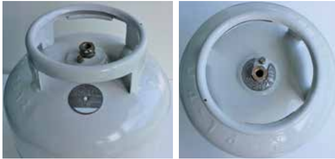
Ferradura e medalhão instalados em botijões.
